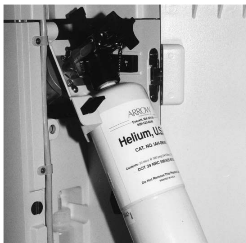
Figura 10.4: Instalación del tanque de helio desechable
